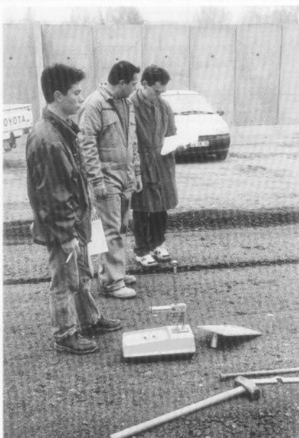
Mesure de densité de MIOM compactés par gammadensimètre
