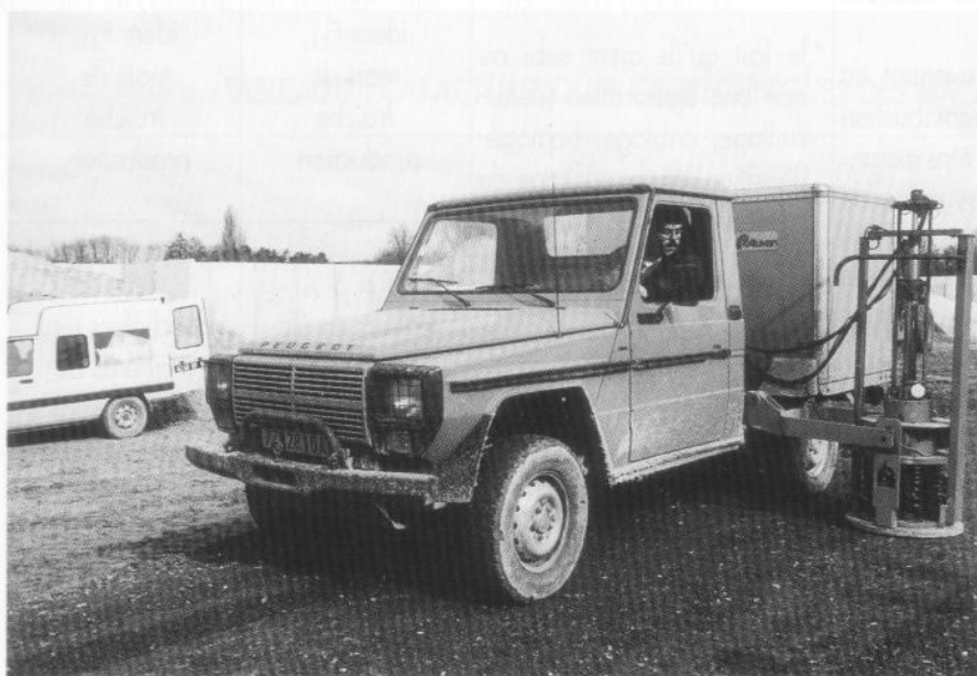
Contrôle de performance à la dynaplaque sur mâchefers utilisés en techniques routières
