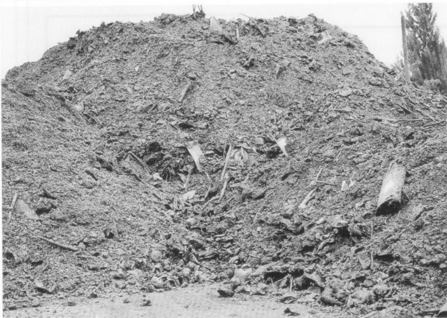
Mâchefers en sortie d'usine d'incinération avant tout traitement
