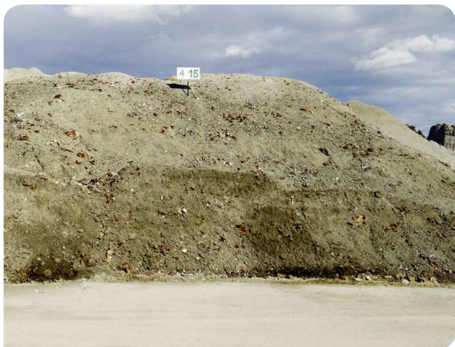
Mâchefers d'incinération de déchets non dangereux (MIDND) avant traitement sur une installation de maturation et d'élaboration (IME)
