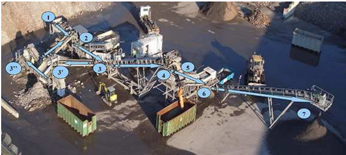
Figure 42 : Schéma de production de mâchefers élaborés sur le site de Plabennec dans le Finistère (29)
