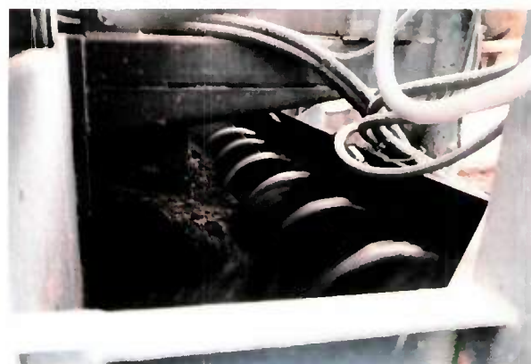
Vis de répartition arrière de l'ARC 700 (APPIA).
