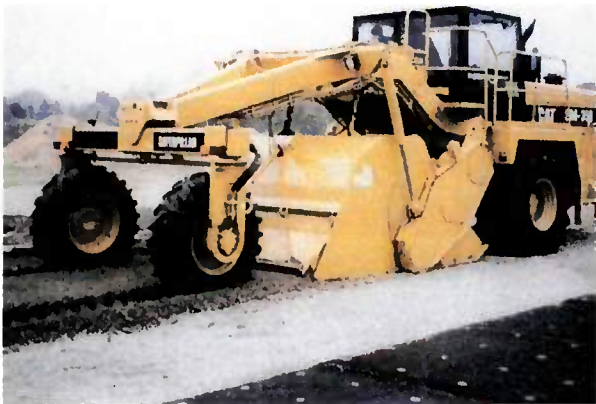
Malaxage vertical suivant l'épaisseur de la chaussée (CARTERPILEAR SM 350).
