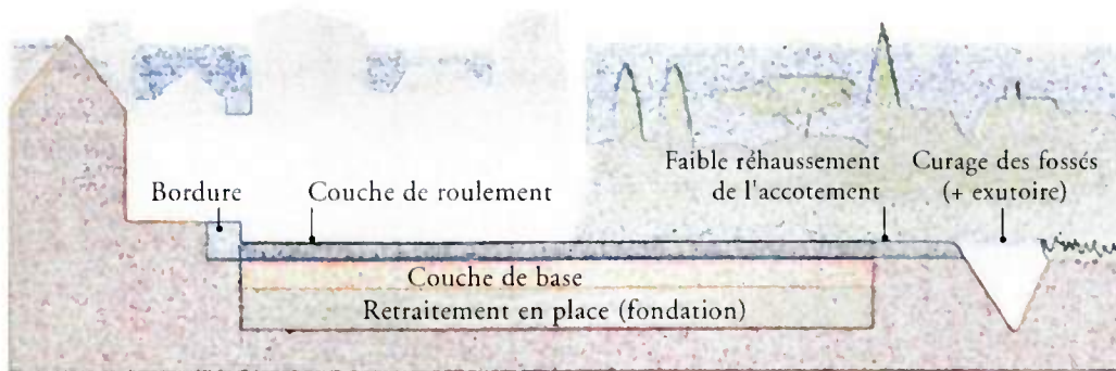
Figure 2 : Exemple de retraitement avec apport d'une couche de base et d'une couche de roulement.
