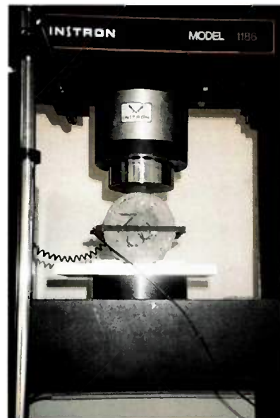
Essai brésilien sur éprouvette.
