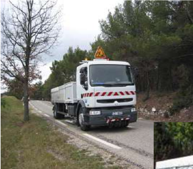
Camion à deux essieux, avec essieu arrière jumelé simple chargé à 13 t.
