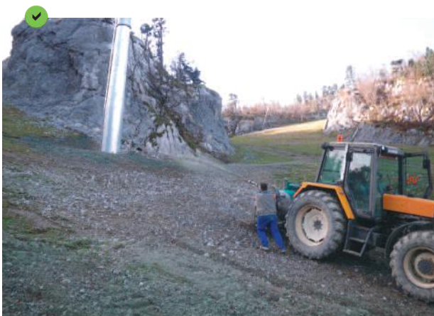
En milieu difficile d'accès, une petite cuve est installée à l'arrière d'un tracteur pour faciliter l'ensemencement.
