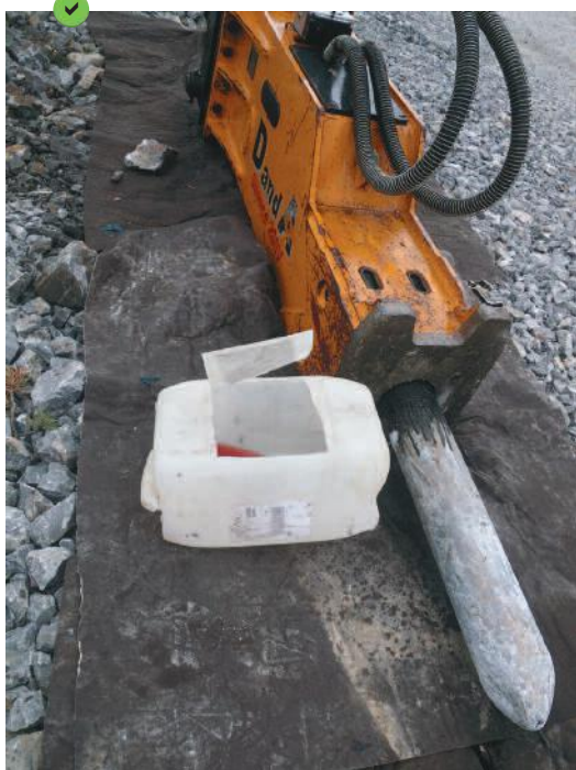
Équipement posé sur géotextile absorbant.
