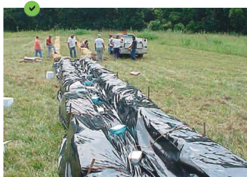
Configuration de traitement pour un pompage et rejet : photo de gauche vue d'aval avec la toile en jute pour retenir les sédiments coagulés, et la photo de droite avec les blocs de PAM attachés le long du fossé de traitement.
