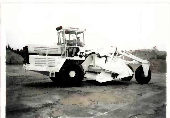
Pulvérisateur de sols de deuxième génération à chambre de malaxage intercalée entre train avant et arrière, épaisseur maximale de la couche malaxée 0,35 m (après compactage).
