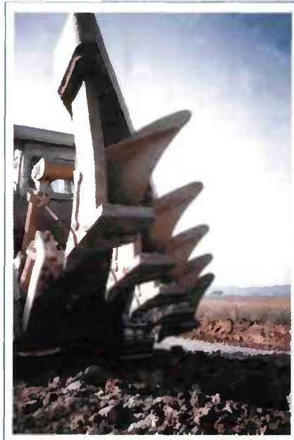
Grosse charrue à socs portée à l'arrière d'un tracteur de 400 CV.
