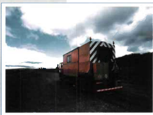
Le déflectographe Lacroix chassis long. Domaine de mesure - Déflexion minimale mesurable : 0,1 millimètre. Cadence de mesure : deux kilomètres par heure à raison de deux mesures tous les cinq mètres.
