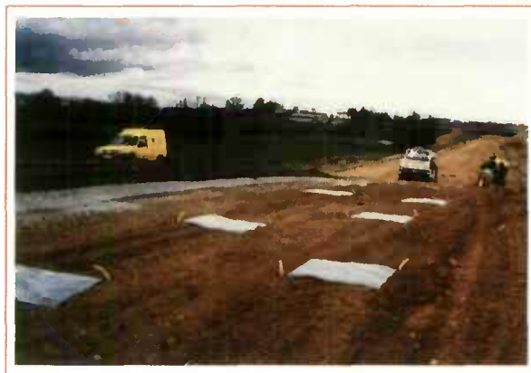
Emplacement des bâches sur la section d'essai retenue (remarquer les repères flexibles placés à deux coins opposés de chaque bâche pour faciliter leur localisation après épandage).
