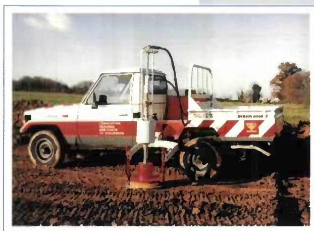
La dynaplaque II. Domaine de mesure : jusqu'à 250 MPa. Cadence de mesure : vingt à trente essais par heure.
