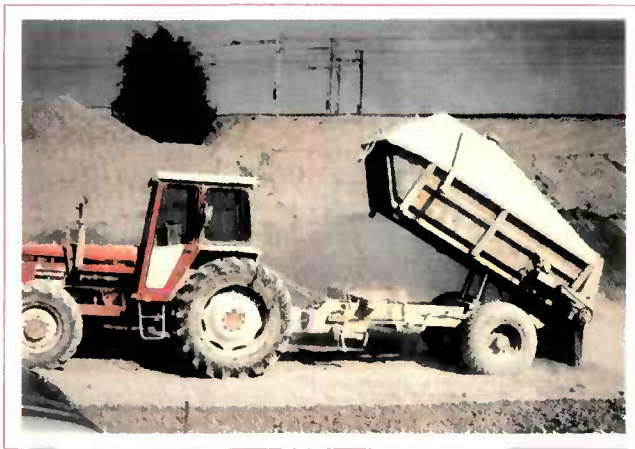
Épandeur de deuxième génération à dosage volumétrique asservi à la vitesse de déplacement de l'engin.
