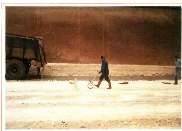
Pesée de l'épandeur avant et après une séquence d'épandage. Mesure de la surface recouverte du produit de traitement.
