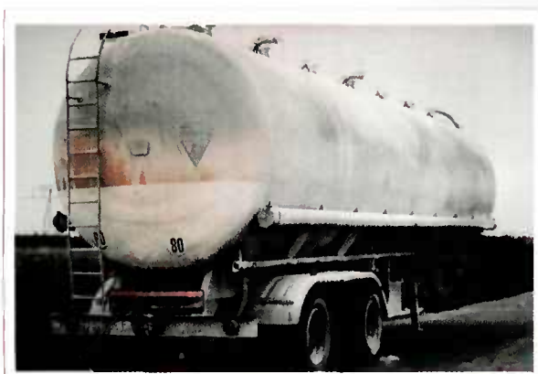
Silo de 30 t constitué par la citerne d'un ensemble de transport routier (qui, après vidange, est reprise et remplacée par une citerne pleine).
