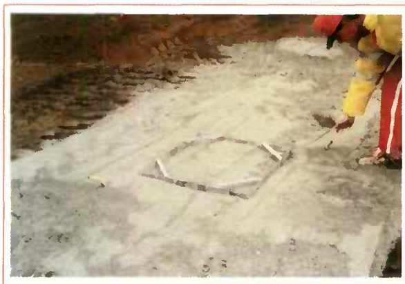
Recherche d'une bâche et emplacement du cadre délimitant la surface prise en compte.
