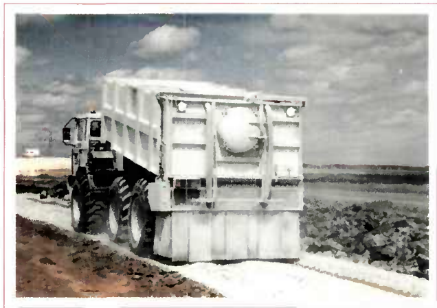
Épandeur de troisième génération à dosage volumétrique asservi à la vitesse de translation et ajusté par un dispositif pondéral.
