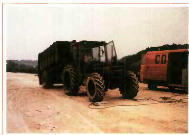
Pesée de l'épandeur avant et après une séquence d'épandage. Mesure de la surface recouverte du produit de traitement.
