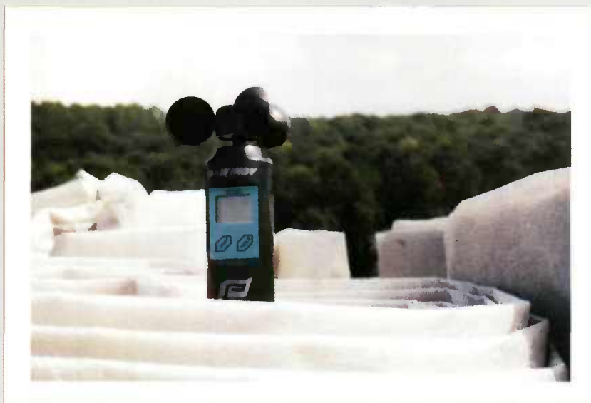
Anémomètre de « poche » permettant la mesure de la vitesse du vent sur le chantier.
