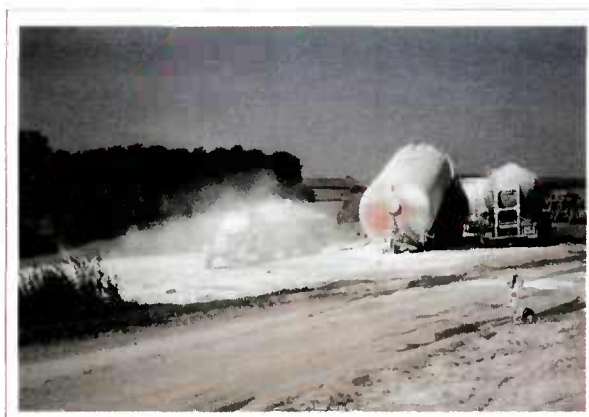
Silos mobiles de 2 X 20 t en cours de remplissage (à remarquer la poussière générée au cours de cette opération).
