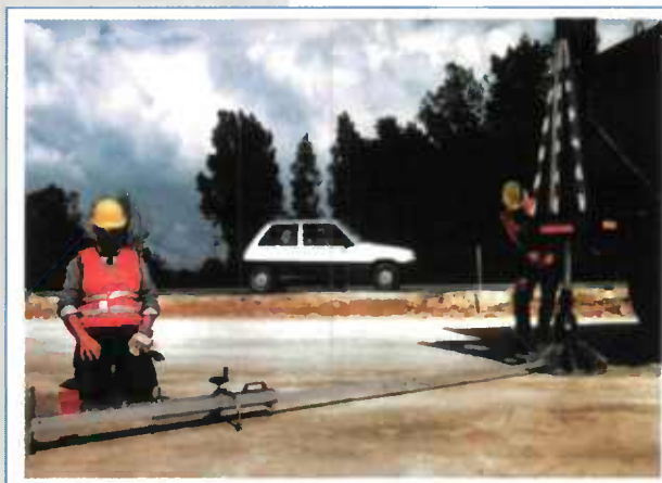
L'essai à la plaque. Domaine de mesure : jusqu'à 250 MPa. Cadence de mesure : deux à quatre essais par heure.
