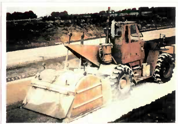
Pulvérisateur de sols de première génération à chambre de malaxage portée à l'arrière du tracteur, épaisseur maximale de la couche malaxée 0,3 m (après compactage).
