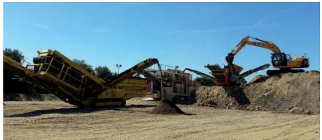
Photo 4 - Plateforme mobile d'élaboration de matériaux chaulés
