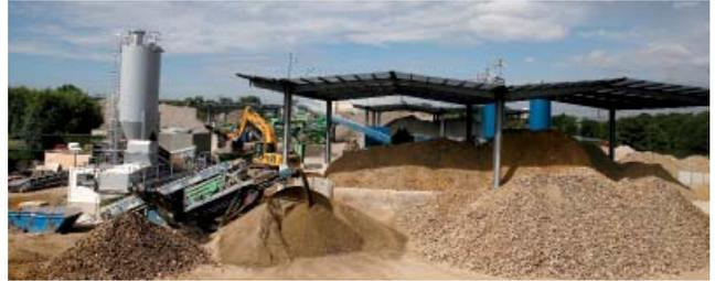
Photo 3 - Plateforme fixe d'élaboration de matériaux chaulés
