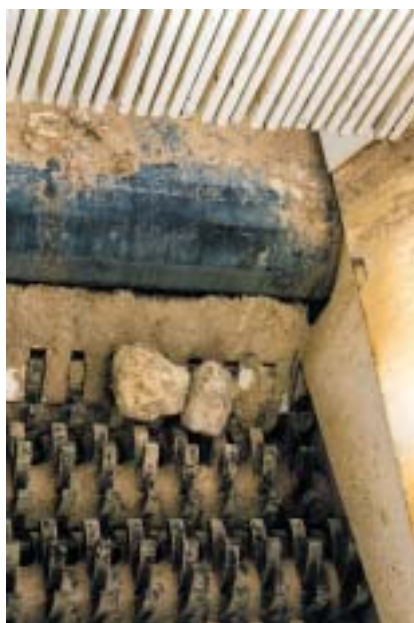
Exemple de cribleur adapté aux matériaux collants : crible à étoiles
