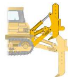
Équipement arrière: dent de ripper ou défonceuse
