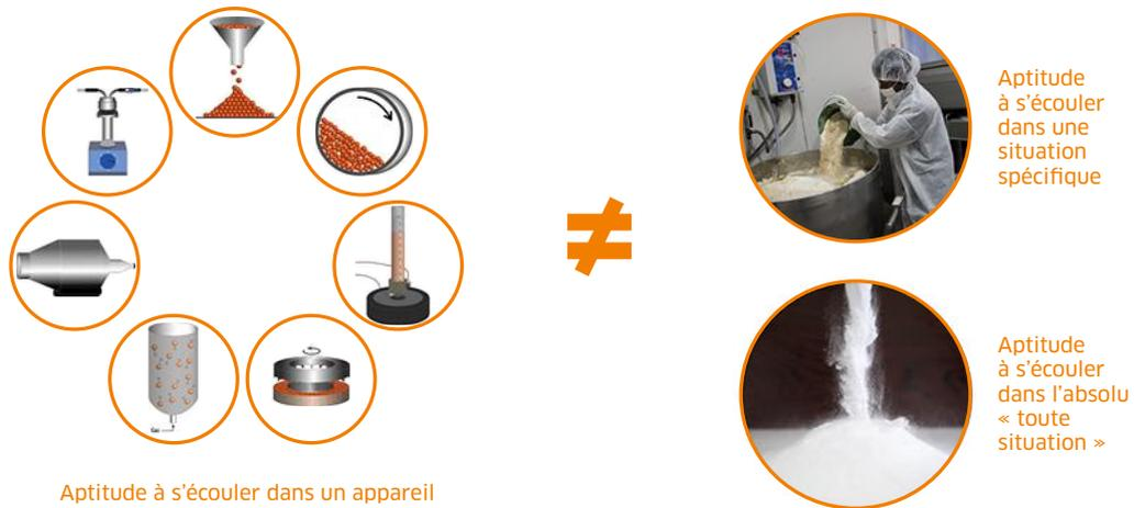
FIGURE 4 → Différence entre coulabilité et aptitude à s'écouler, la complexité de la prédiction.
