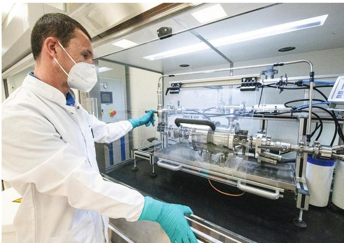
Le petit tambour rotatif est un dispositif de mesure permettant de caractériser l'émission d'aérosols à partir de poudres (ou pulvérulence). Essai en laboratoire à l'INRS.
