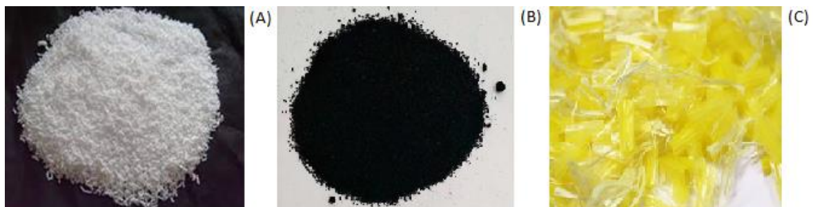
Figure 7.1.1-1 : Modificateurs de bitume : SBS (A) caoutchouc en miettes (B) fibres synthétiques (C) [7.1.1-2, 7.1.1-3].
