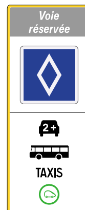
Signalisation d'information de la VR2+, largeurs réduites
