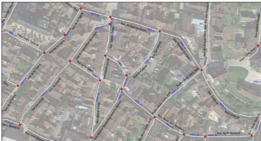
Figure 3 : Exemple d'un référentiel où les intersections et limites des tronçons sont matérialisés par les points rouges
