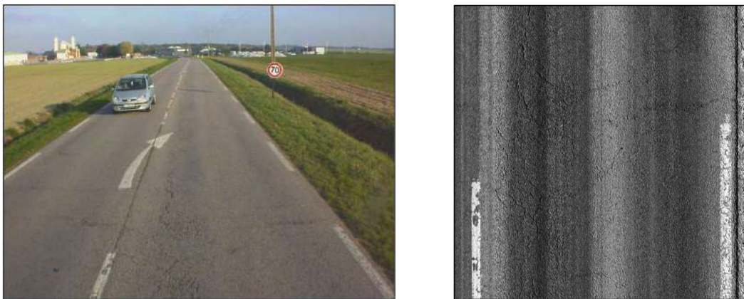
Figure 9 : Photo de dégradations (à gauche) et images LCMS de dégradations (à droite)
