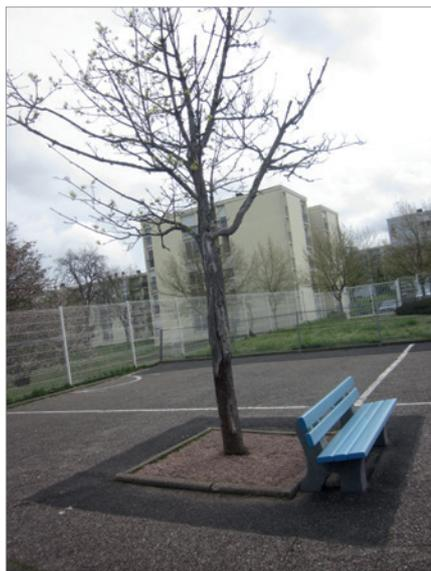
*Les bordures surélevées ne permettent pas aux eaux pluviales de s'infiltrer au pied de l'arbre et dans les zones enherbées dans cette cour d'école à Avon.*
