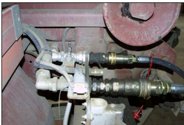
Figure 17 : Branchement des prises (Source : SECMAIR)
