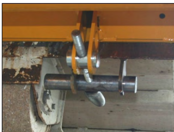
Figure 14 : Visser le gravillonneur de chaque côté (Source : SECMAIR)
