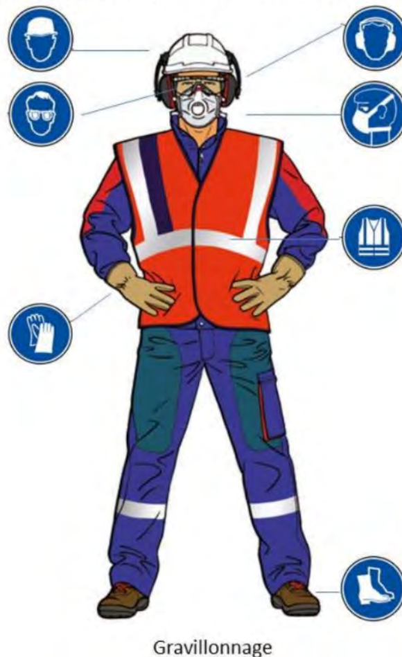
Figure 31 : Présentation des EPI pour un ouvrier d'application / ouvrier sur gravillonneur porté
