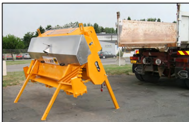
Figure 11 : Recul du camion vers le gravillonneur (Source : SECMAIR)
