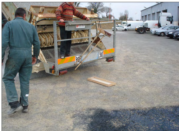
Figure 27 : Vérification du taux d'épandage
