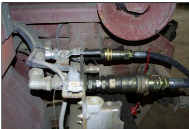
Figure 18 : Branchement des prises électriques et fermeture de la vanne (Source : SECMAIR)
