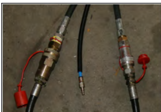
Figure 15 : Branchement des prises (Source : SECMAIR)
