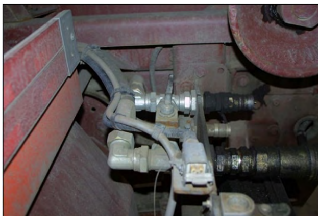
Figure 16 : Non-connexion des prises (Source : SECMAIR)
