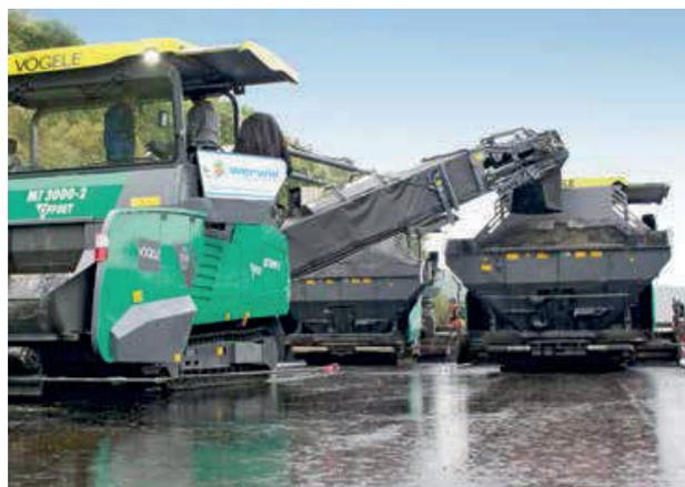
**Photo 5** : Exemple d'alimentation d'un finisseur en déporté
