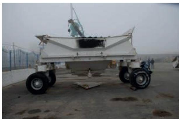
**Photo 7** : Exemple de trémie «enjambeuse»
