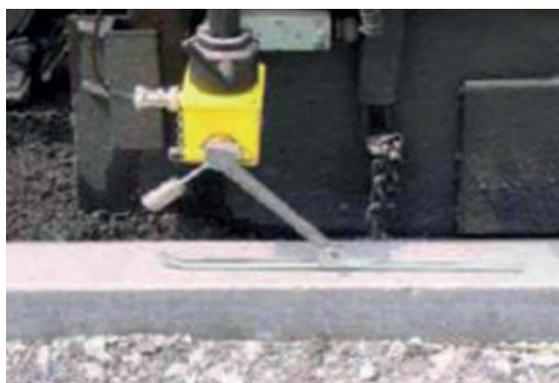
**Photo 9** : Dispositif de palpeur mécanique avec référence par ski
