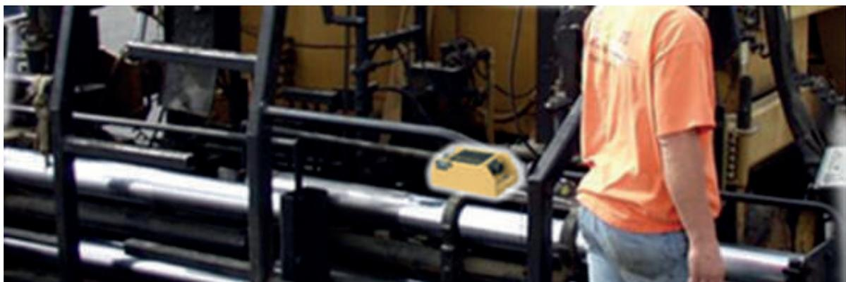
Photo 11: Palpeur mécanique par pendule
