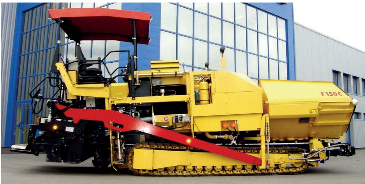
**Photo 3** : Exemple de finisseurs à rampe intégrée
