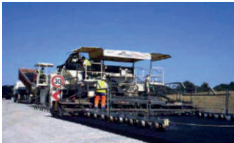
Photo 10 : Palpeur mécanique par poutre enjambeuse
