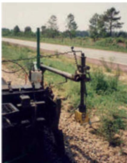
**Photo 8** : Dispositif de palpeur mécanique avec référence sur fils
