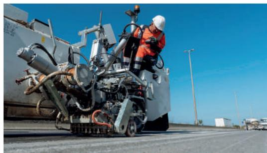
Figure 12 : Exemple d'application d'enduits à chaud en rideaux
