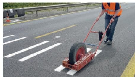
Figure 2 : Exemple de mesure du séchage du produit
