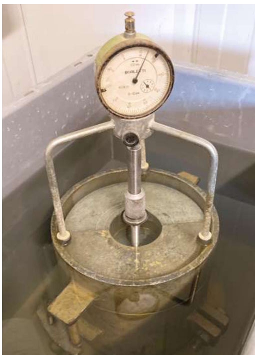
Photographie 3: Moule CBR immergé (Source : Eiffage)
