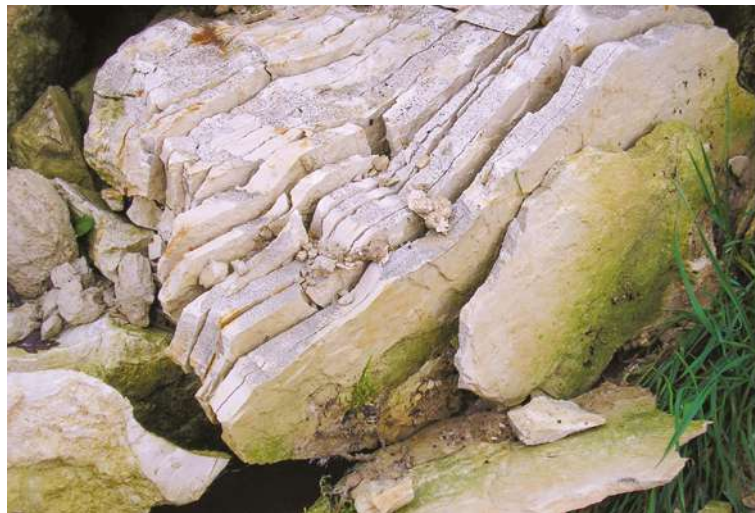
Photographie 9: Calcaire biodétritique gélif (Source : Eiffage)
