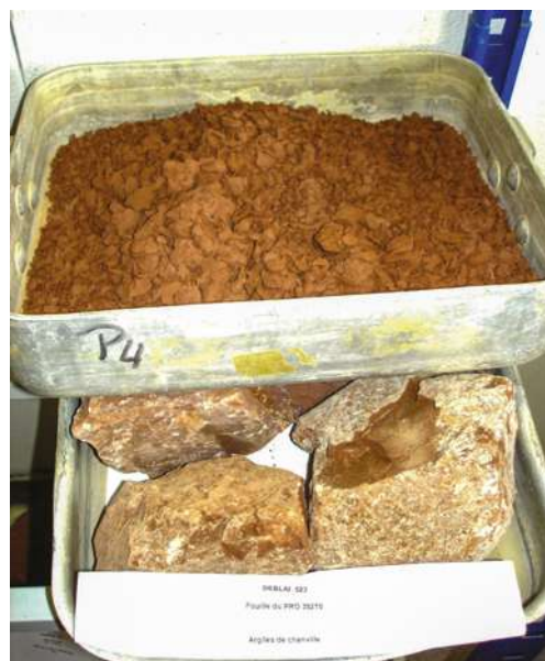
Photographie 6: Marne évolutive en bloc (en dessous) marne après évolution (au-dessus) (Source: Eiffage)
