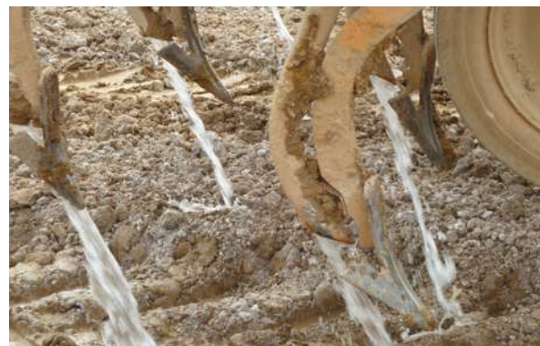
Photographies 14 et 15 : Humidification par enfouisseuse (Source : SCSNE)
