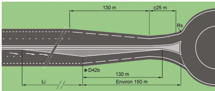
169 Cette disposition, permettant l'implantation du panneau D42b au terme du rabattement de deux à une voie, se substitue à celle représentée au point 2.4 du chapitre 3 d'ACI.
