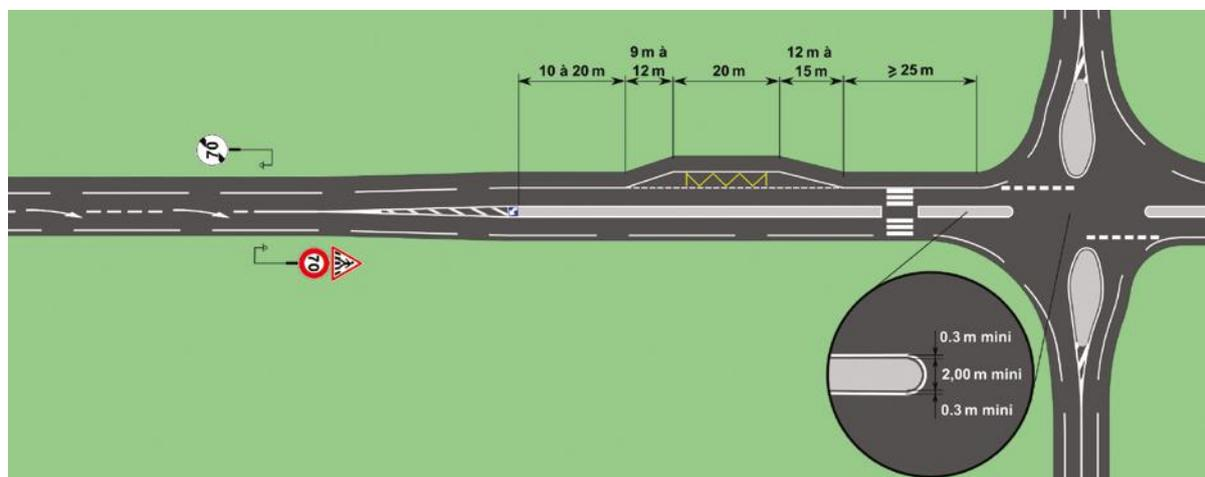
122 Dans le cas d'un traitement localisé de l'accotement en bande cyclable (cf. point 2.2 du chapitre 1), les lignes d'effet de priorité sont disposées en retrait de celle-ci. Le recul résultant de la position d'un conducteur en attente au carrefour sur la route non prioritaire est à prendre en compte pour la vérification des conditions de visibilité en carrefour (cf. point 4 du chapitre 2).
