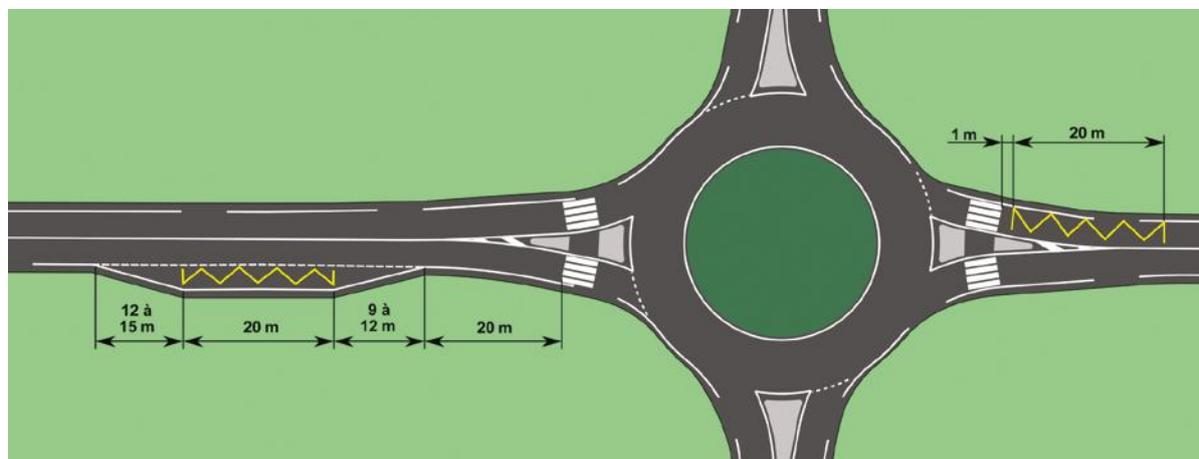
Lorsque l'entrée et la sortie du giratoire empruntées par les transports en commun sont à deux voies, une implantation en ligne de l'arrêt TC est à exclure. Une implantation en encoche ou retrait reste peu recommandée, celle en entrée étant moins pénalisante que celle en sortie.
