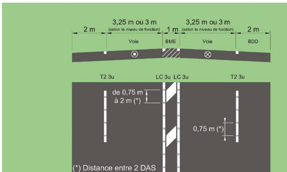
**Figure 22 : Profil en travers et vue en plan d'une route à 3 voies affectées, avec BME équipée de hachures et d'alerte sonore**
