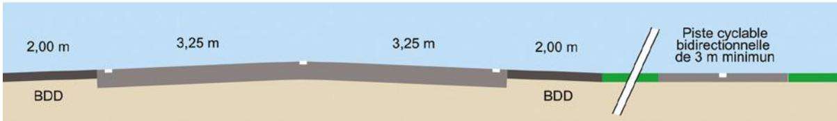
Figure 11 : Profil en travers d'une route ordinaire à 2 voies avec niveau de fonctions modéré
