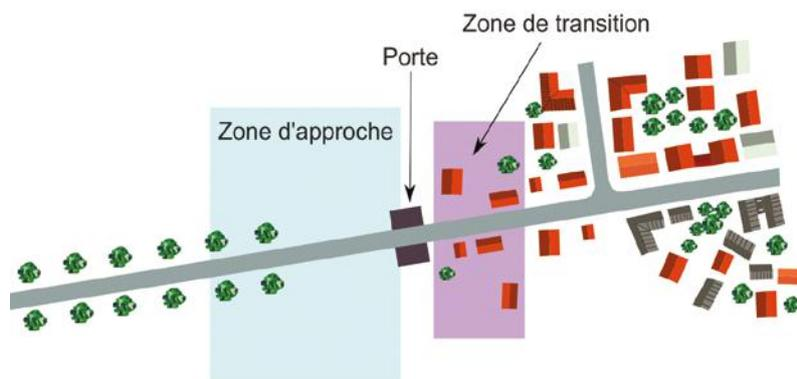
La zone d'approche permet d'introduire un changement d'environnement (par exemple, une évolution de l'environnement végétal<sup>159</sup>, une réduction de la largeur roulable, etc.) pour contribuer à une diminution des vitesses des usagers.
