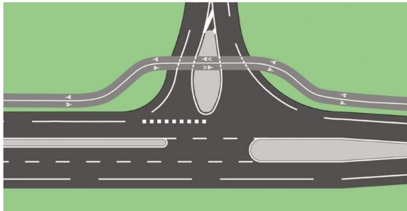
S'agissant des cycles pouvant emprunter la BDD, la mise en retrait de la pointe d'îlot de voie secondaire en saillie vis-à-vis de la largeur revêtue de BDD (cf. point 2.3 du chapitre 5) permet de favoriser leur passage en sécurité au niveau du carrefour. En outre, la mise en place d'un marquage par double chevrons et/ou pictogramme cycliste sur la BDD, en amont et en aval du carrefour, peut permettre d'indiquer leur cheminement possible.
