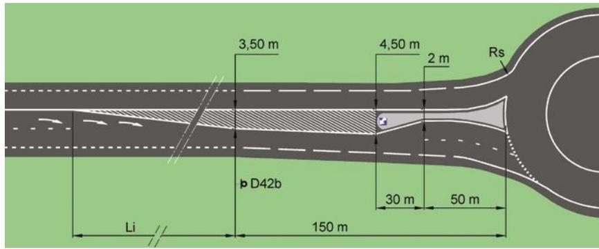
Figure 46 : Approche à 2 voies d'un giratoire depuis une route à 3 voies affectées, avec entrée à 1 voie
