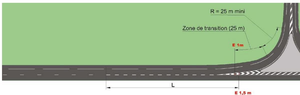
La construction de l'entrée se distingue de celle en insertion par l'absence de biseau de rabattement. Le marquage T2-5u de séparation entre la route principale et la voie d'entrée est alors implanté sur une longueur L définie dans l'IISR à compter du point E, 1,50 m.
